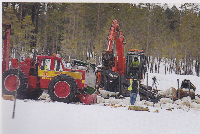
Man använde terrängbärgaren och en grävare för att hjälpa skotaren upp. Foto: Björn Hollén
