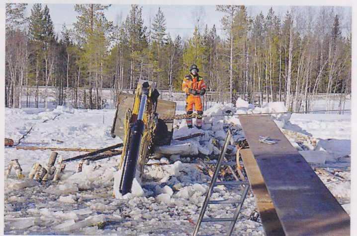
Vajerspelet till tungbärgaren är fjärrstyrt. Foto: Bitte Torbjörnsdotter
