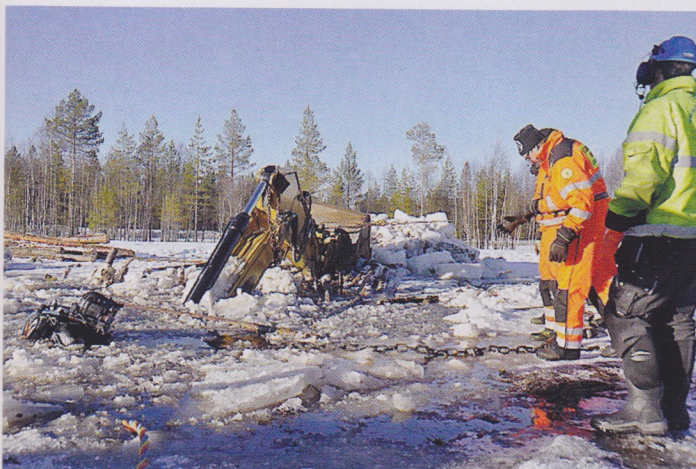
Alexander får ta en kedja med sig fem, sex meter ner för att få den runt ena larvbandet. Foto: Bitte Torbjörnsdotter
