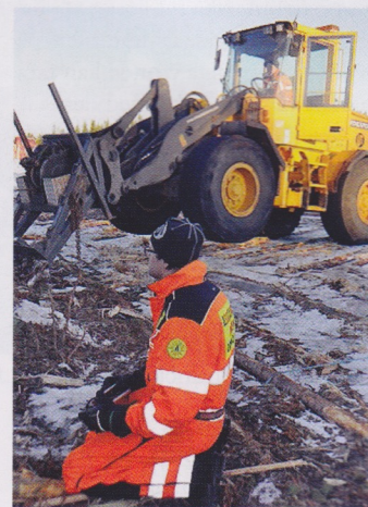
Ume Assistance har en egen baklastare på plats som spänner ena vajern. Foto: Bitte Torbjörnsdotter
