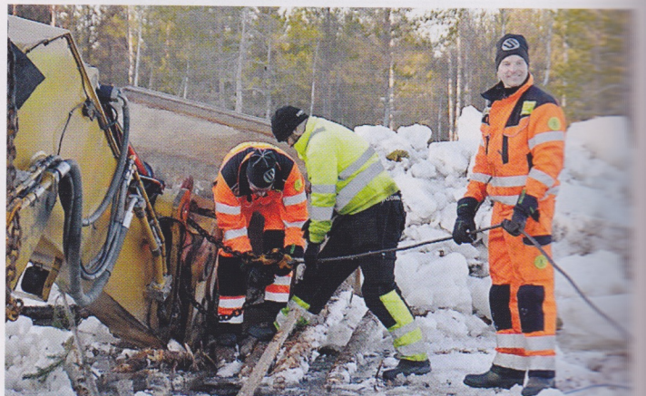
En kedja och vajer ska spännas bättre runt grävarens arm. Foto: Bitte Torbjörnsdotter
