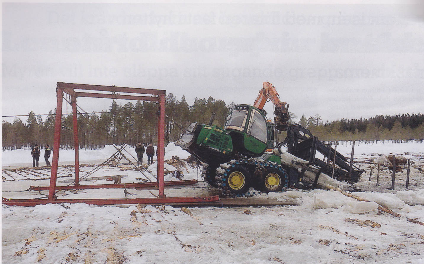
När skotaren var uppe på fast mark återstod en massa skruvning för att få loss bromsarna innan bärgarna kunde ta maskinen därifrån på trailer. Foto: Ume Assistance
